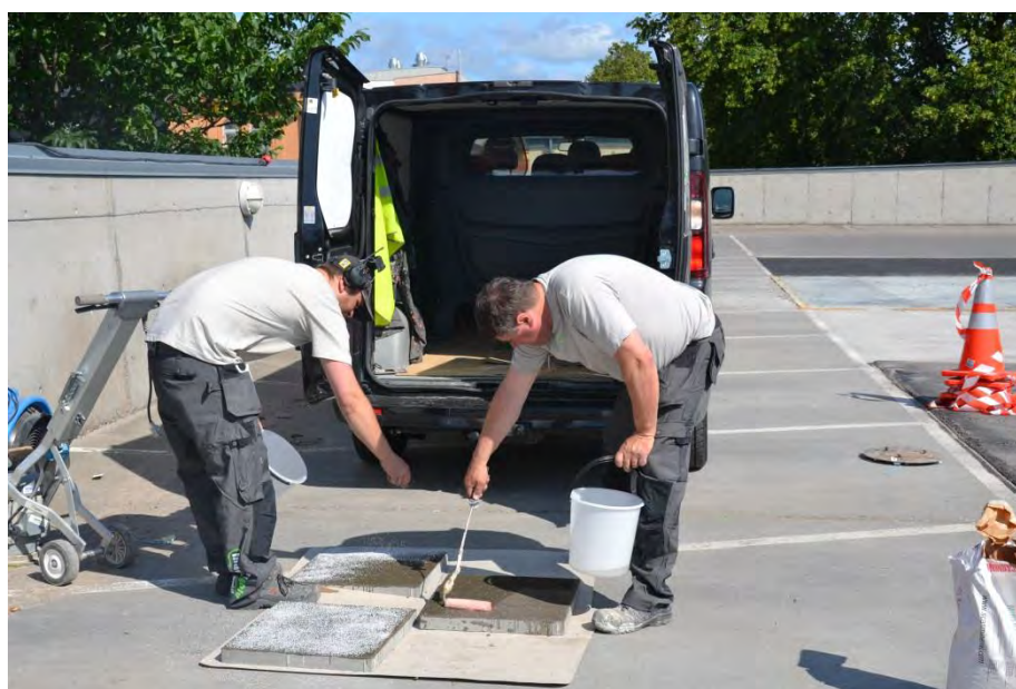
Figur 2.10 Även provplattorna primerbehandlas (Foto: Y Edwards)
