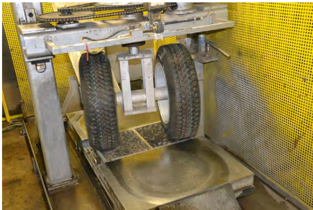
Figur 2.42 Utrustning för provning av Scuffing resistance, med dubbdäck (Foto: Y Edwards)
