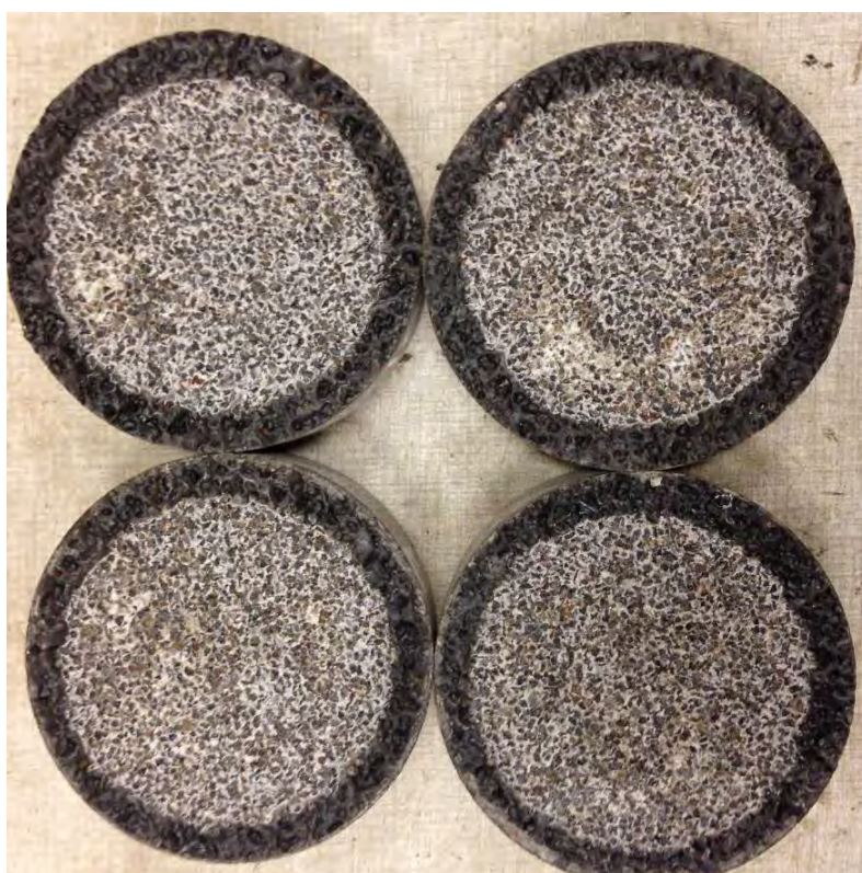
Figur 2.62 Akryl – Duracon efter prøvning enligt Prall
