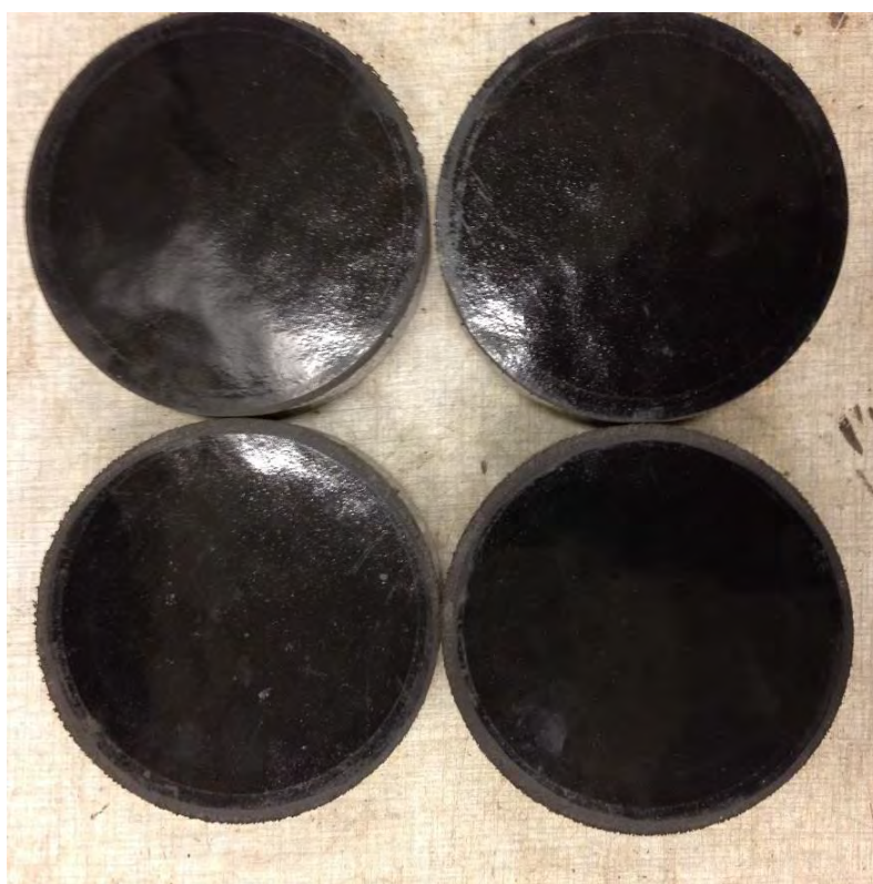
Figur 2.60 Polyurea – Micorea HS efter provning enligt Prall
