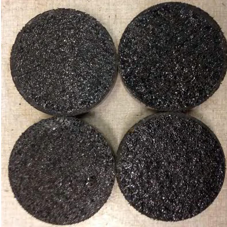
Figur 2.57 Polyurea – Purtop 1000 efter prøvning enligt Prall
