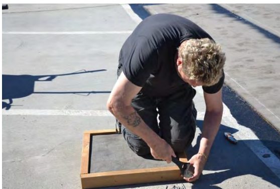
Figur 2.18 Provplattan som ska till VTI förses med ram inför appliceringen av gjutasfalt (t v). Provplattor med stålbotten (t h) ska förses med gjutasfalt och skickas till ISAC i Aachen (Foto: Y Edwards)
